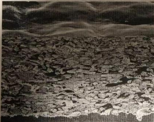
图 1-3 合成革的微观组织构造
