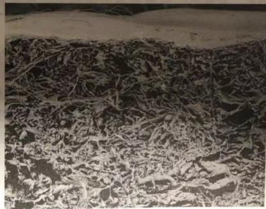
图 1-4 超纤革的微观组织构造
