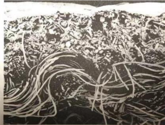
图 1-2 人造革的微观组织构造
