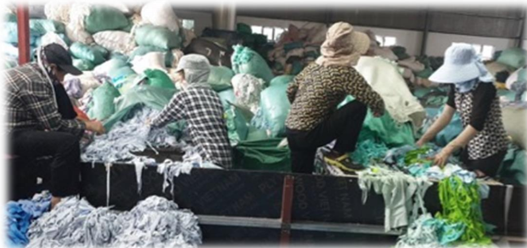
Phân loại trên mặt sàng để dễ loại bỏ tạp chất (rơi xuống dưới)
