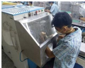
Hoạt động cân thô khép kín với LEV tích hợp trong sản xuất giấy da ở Myanmar
