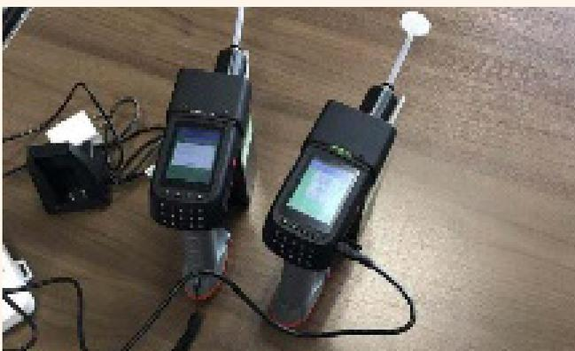
为进行挥发性有机化合物筛查，需要一台光电离检测筛查设备 (光电离检测器，请参见照片)。
